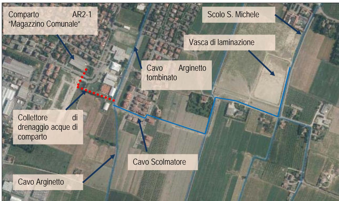
Figura 23: Inquadramento planimetrico reticolo secondario di pianura.
