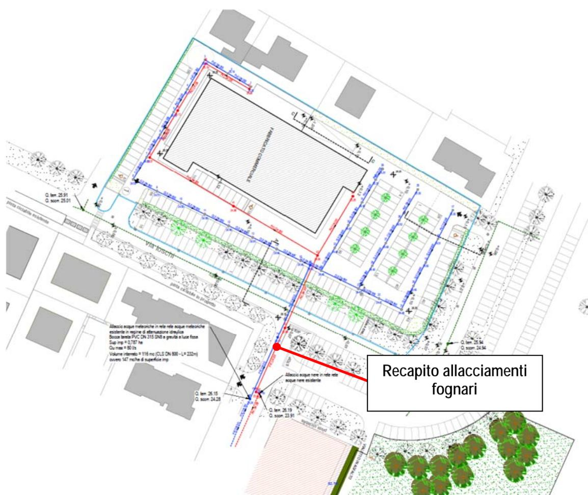
Figura 16: Lay-out area con schema reti di drenaggio acque meteoriche.
