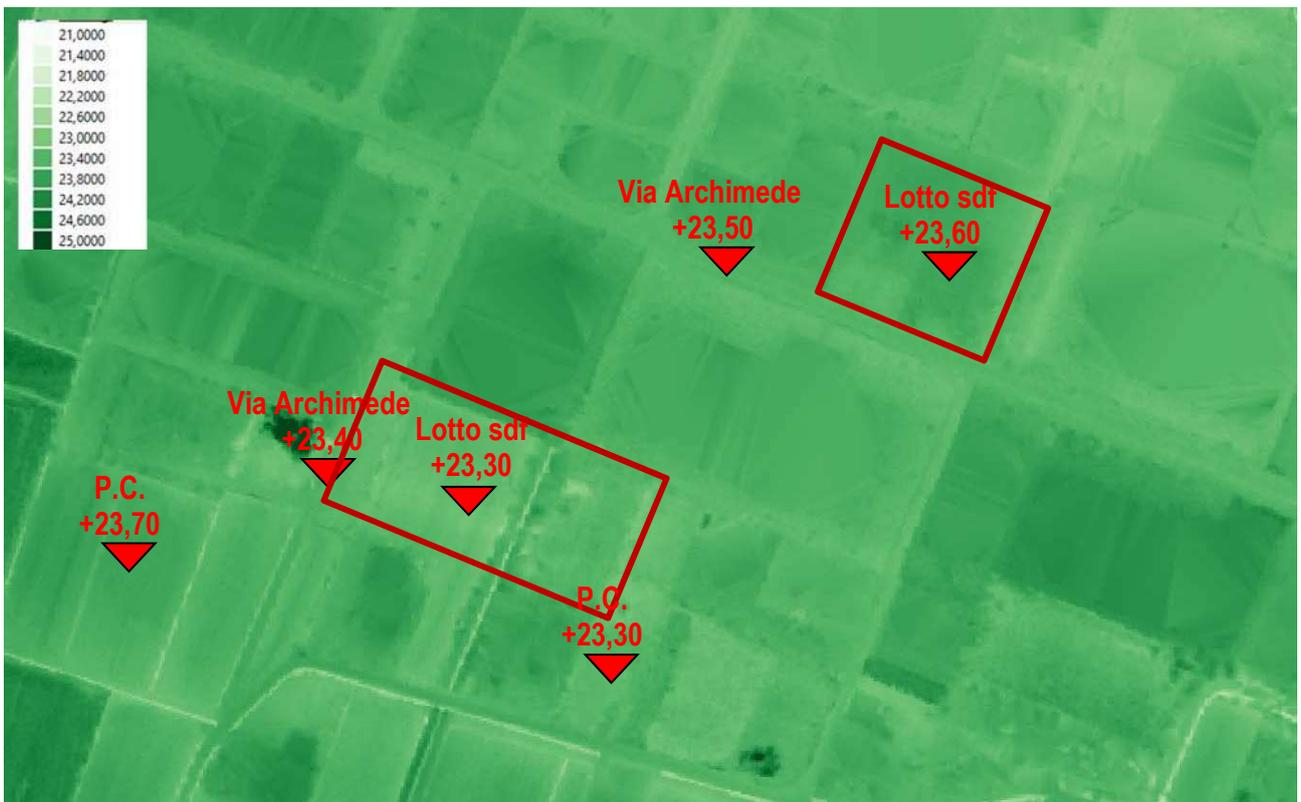
Figura 20: Analisi LiDAR dell'area oggetto di studio, scala 1:2.000.
