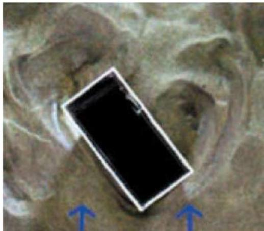
Figura 27: Esperimento di laboratorio, Dipartimento di Idraulica, Università di Pavia. Vista dall'alto di uno ostacolo rettangolare posto su letto sabbioso in seguito a simulazione.
