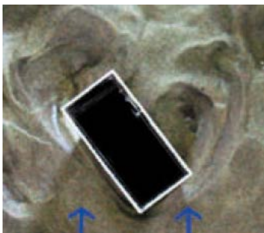
Figura E: Esperimento di laboratorio, Dipartimento di Idraulica, Università di Pavia. Vista dall'alto di uno ostacolo rettangolare posto su letto sabbioso in seguito a simulazione.
